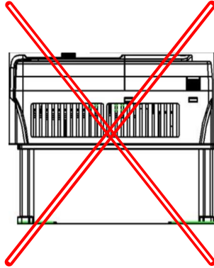
نصب نا صحیح نصب خوابیده
