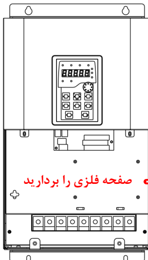
جامپر EMC در درایوهای 7.5~15kw
